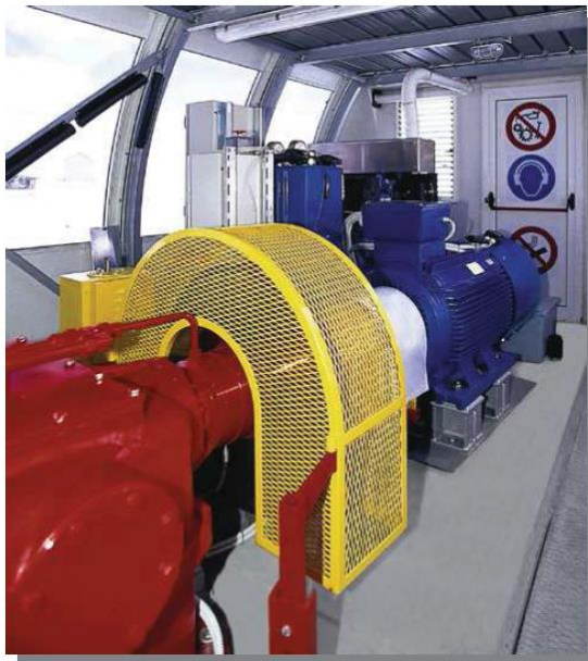
Pogonska jedinica: E-Motor, radna kočnica, prenosnik
