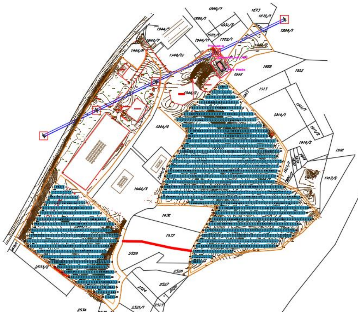
Slika 1: Lokacije SE - Opština Bijelo Polje, KO Zaton – geodetski snimak sa rasporedom solarnih panela
