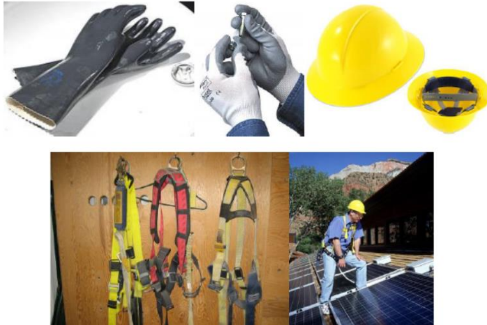
Slika 15. Zaštitna oprema koju treba nositi prilikom instalacije opreme
